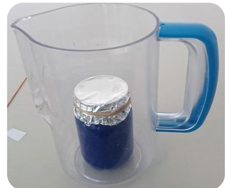
**3** Giesse das Eiswasser an der Gefässwand entlang in das grosse Gefäss, ohne dass der kleine Behälter dabei gestört wird. Das kleine Gefäss muss mit etwa 3-5 Zentimeter Wasser bedeckt sein.
