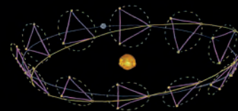
Flugbahn von LISA in der Umlaufbahn der Erde
